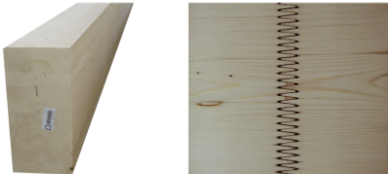
Abb. 3: Brettschichtholz; Keilzinkung einer BSH-Lamelle
