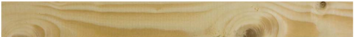
Abb. 1: Holzoberfläche mit Ästen (Fichte)
