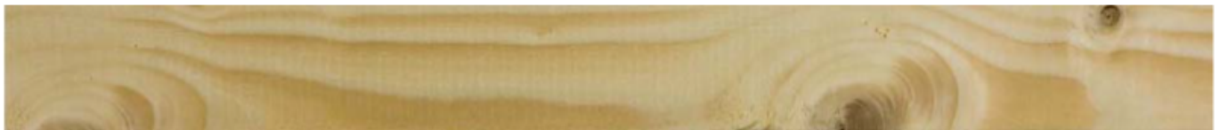
Abb. 1: Holzoberfläche mit Ästen (Fichte)
